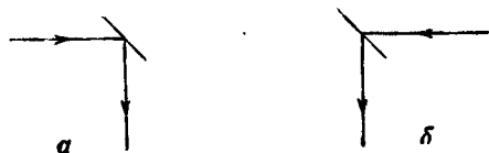
Фиг. 14. Рассеяние фольгой на 90^\circ . а—случай «отражения»; б—случай «прохождения».
